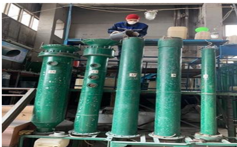
2.4 - сурет – Шаймалау жүргізілетін бағандардың жалпы түрі
