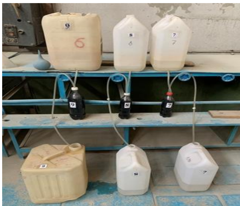
2.6 - сурет – Шаймалаудан кейінгі алынған ерітінділерді сорбциялаудың жалпы көрінісі
